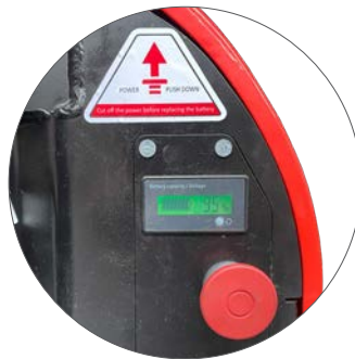
Batterieladestand- und Betriebsstundenanzeige mit Not-Aus-Knopf
