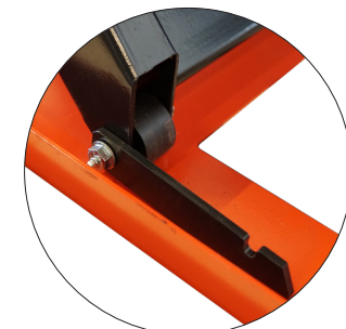
zusätzliche Sicherheit bei der Wartung des Hubtisches
