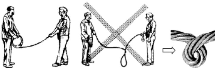
2. Bei Vertikalzug Last nicht pendeln lassen und Last gegen Verdrehen sichern, sonst Schädigung Des Seiles durch Entdrallung.
