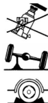
Tragfähigkeit entsprechend technischem Datenblatt bzw. Typenschild, nicht überschreiten.
