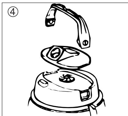
**Mise en place du collecteur de soufflerie 11562000****B-1.3.5****8****Mise en place du collecteur de soufflerie par remplacement de la grille et du diffuseur**
