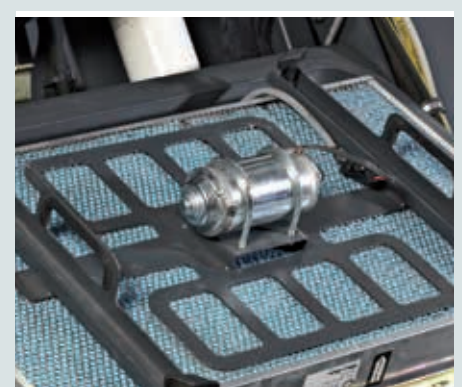
Zum Patent angemeldeter Multi-Spektrum Filtrerrüttler verhindert Staubansammlungen und Verstopfungen am Hauptfilter.
