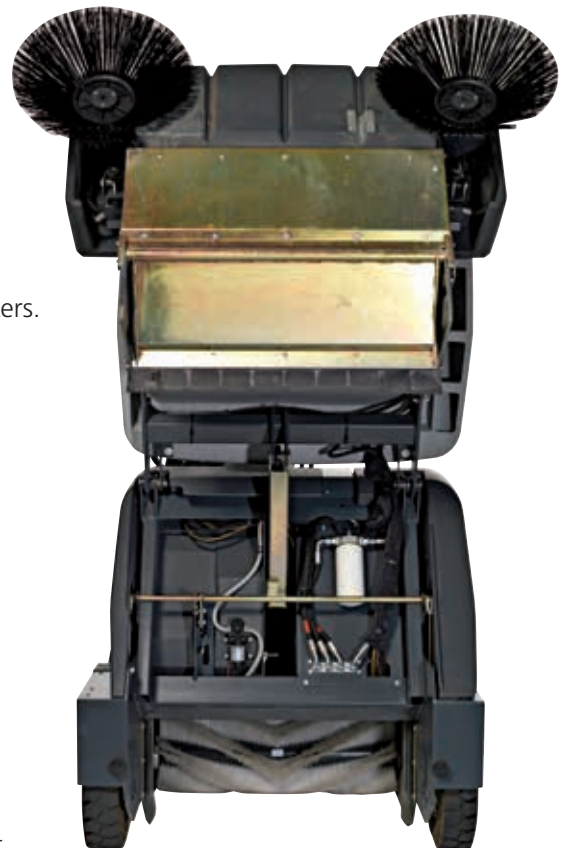
Der hydraulische Hochentleerungsbehälter der SR1601 ermöglicht Entleerungshöhen bis zu 154 cm über Flur.
