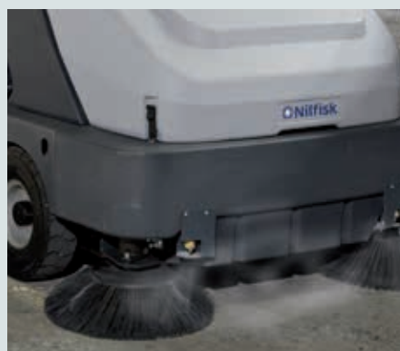
Das exklusive DustGard™ System verhindert Staubaufwirbelungen mit einem feinen Wassernebel, der die Vorderseite der Bürsten benetzt.
