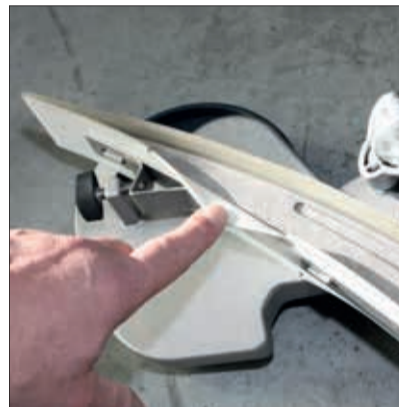
2. Reinigen und prüfen der Absaugleiste und Gummis.
