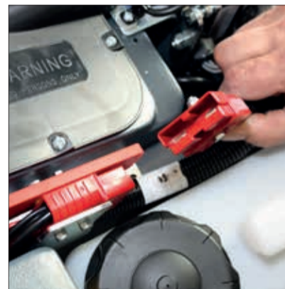
3. Kontrolle des Ladegeräts und Prüfung der Ladekabel.
