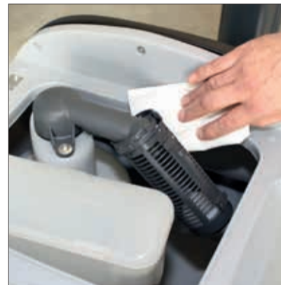
3. Reinigung und Kontrolle des Abwassertanks und des Schwimmers.
