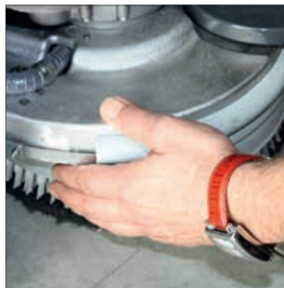
4. Entfernen und Reinigen der Bürsten oder Pads.
