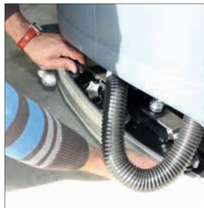
2. Einstellen der Absaugleiste, so dass die Maschine keine Wasserstreifen zieht.
