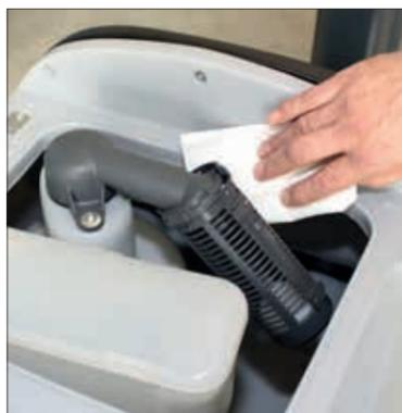
3. Deckel hochklappen und Verunreinigung entfernen.
