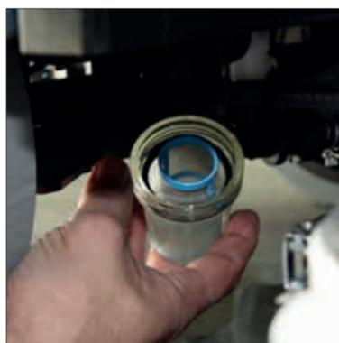
1. Überprüfen des Frischwasserfilters.
