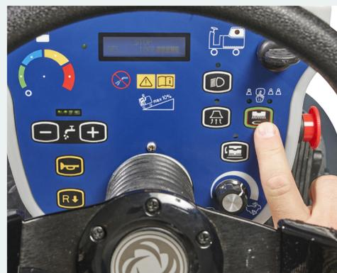
Automatisches Absenken/Anheben der Bürsten und der Saugleiste für weniger Arbeitsaufwand
