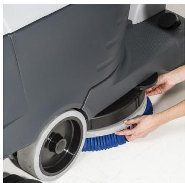
1 Prüfen Sie, ob die Bürsten korrekt eingebaut und nicht abgenutzt sind.
