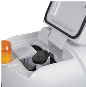
2 Den Schmutzwassertank öffnen und kontrollieren, ob Grobschmutzfilter und Schwimmer sauber und funktionsfähig sind.
