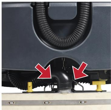
1 Prüfen Sie, ob der Saugschlauch richtig installiert und frei von Verschmutzung ist.
