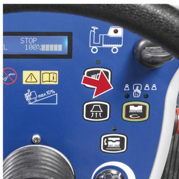
2 Kontrollieren Sie, ob der Bürstenmotor nicht überlastet ist (durch Blinken der LEDs angezeigt).
