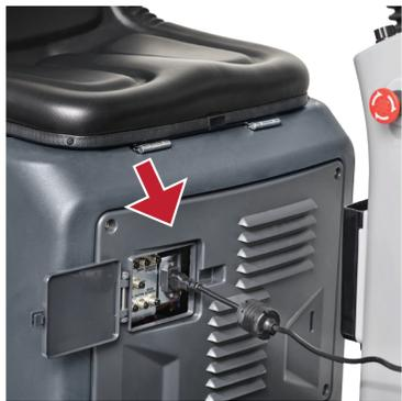
1 Prüfen Sie, ob das Stromkabel korrekt angeschlossen ist.
