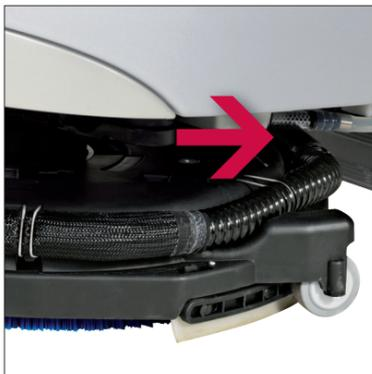
1. Ist der Saugschlauch richtig montiert?
