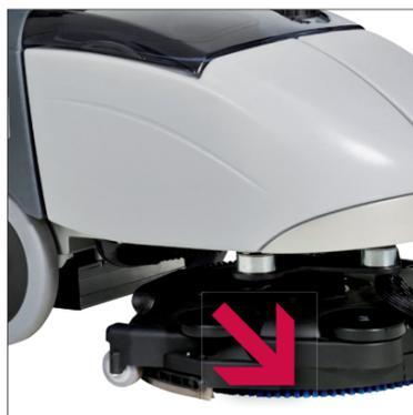
2. Überprüfen Sie die Bürste auf Fremdkörper, die die Drehung behindern und entfernen Sie diese gegebenenfalls.
