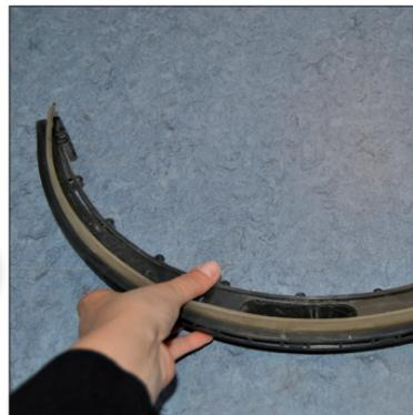
3. Überprüfen Sie die Saugleiste und Sauglippen auf Beschädigungen und reinigen diese gegebenenfalls.
