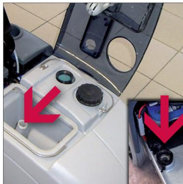
2. Öffnen des Tankdeckels und Überprüfung ob sich Verunreinigungen in der Absaugung befinden.
