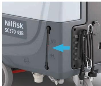
6. Überprüfen Sie den Stand der Reinigungslösung anhand der Anzeige mit der roten Kugel auf der linken Seite der Maschine.
