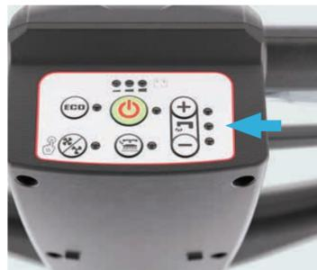
8. Drücken Sie die Taste + oder –, um den Durchfluss der Reinigungslösung zu erhöhen bzw. verringern.
