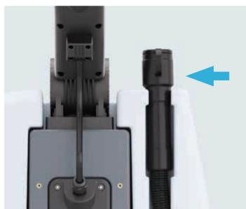
12. Täglich: Entleeren Sie den Schmutzwassertank mit dem dafür vorgesehenen Schlauch. Formen Sie den Schlauch vor dem Entfernen der Kappe so, dass Sie den Durchfluss besser steuern können.
