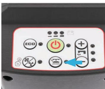
15. Täglich: Drücken Sie bei eingeschalteter Maschine und angehobenem Deck die Klick-Off-Taste, um den Bürsten-/Padhalter zu lösen und reinigen. Überprüfen Sie ihn vor dem nächsten Gebrauch.
