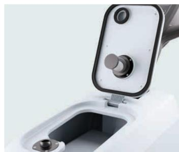
13. Täglich: Überprüfen und spülen Sie den Korb des Schwimmers und reinigen Sie ggf. die Deckeldichtung.
