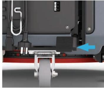
2. Heben Sie das Deck durch das Betätigen des Pedals an.
