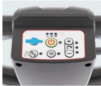
4. Drücken Sie bei eingeschalteter Maschine einen der Sicherheitsschalter, um den Bürsten-/Padhalter zu aktivieren und lassen Sie den Schalter dann los. Wiederholen Sie ggf. den Vorgang, bis der Bürsten-/Padhalter eingerastet ist. Die Saugleiste wird mit dem Deck angehoben und abgesenkt.
