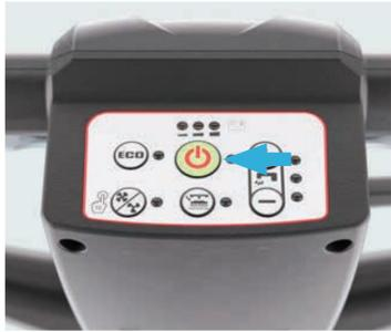
1. Schalten Sie die Maschine ein und vergewissern Sie sich, dass die Batterieleistung ausreicht ist, um die Reinigungsaufgabe durchzuführen. Laden Sie die Batterie ggf. auf.
