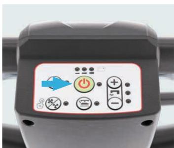
10. Sobald die Reinigung abgeschlossen ist, schalten Sie die Maschine aus. Führen Sie dann die folgenden Wartungsarbeiten durch.
