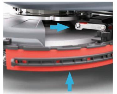
9. Heben Sie die Saugleiste manuell an bis sie einrastet und schalten Sie die Absaugung für doppeltes Schrubben aus. Um in den Arbeitsmodus zurückzukehren, setzen Sie die Saugleiste mit dem roten Hebel nach unten und schalten Sie die Absaugung wieder ein.
