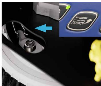
8. Heben Sie die Bürste an und drehen Sie sie nach links, um sie in ihrer Position zu verriegeln. Wenn eine Click-on-Option verfügbar ist, richten Sie die Bürste mithilfe des Systems direkt unter dem Motor aus und drücken Sie die Taste zur Bürstenaufnahme (nur bei Tellerbürsten-Version).
