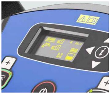
1. Batterieladeanzeige prüfen (und ggf. Batterie aufladen).
