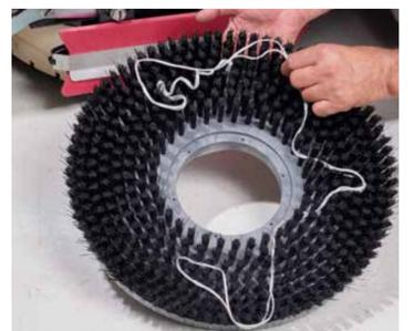
15. Drehen Sie die Bürsten gegen den Uhrzeigersinn und nehmen Sie die Bürsten oder Padhalter ab. Spülen Sie die Bürsten oder Pads mit warmem Wasser aus und hängen Sie sie zum Trocknen auf.
