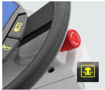
2. Wenn das Not-Aus-Symbol auf dem Display angezeigt wird, den Knopf drehen, bis er herauspringt, um die Maschinenfunktion wieder zu aktivieren.
