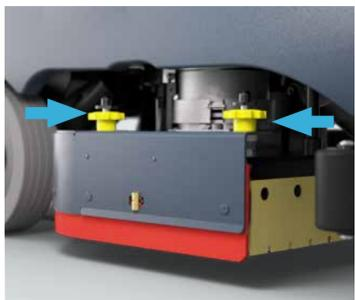
6. Montieren Sie die Bürsten, indem Sie die seitlichen Sauglippen abnehmen. Sie werden durch das Lösen der Stellschrauben entfernt.
