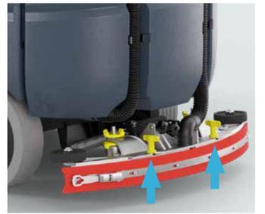
5. Überprüfen Sie die Sauglippen auf Beschädigungen. Setzen Sie die Saugleiste ein und befestigen Sie diese mit den gelben Stellschrauben. Ändern Sie bei Bedarf die Höhe der Saugleiste durch Verstellen der Lenkrollen und des Neigungshebels.
