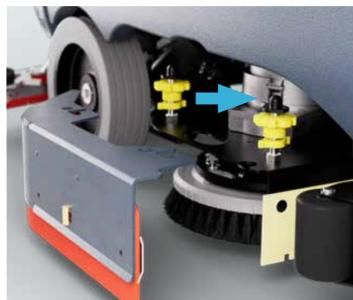
9. Entfernen Sie die Seitenverkleidung und setzen Sie sie auf die schwarzen Stifte, wenn doppeltes Scheuern erforderlich ist.
