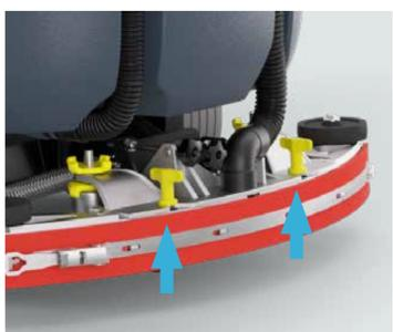
16. Nehmen Sie die Saugleiste ab und entfernen Sie den groben Schmutz. Prüfen und reinigen Sie die Sauglippen.
