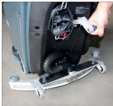
8. Senken Sie die Saugleiste mit dem Hebel ab.
