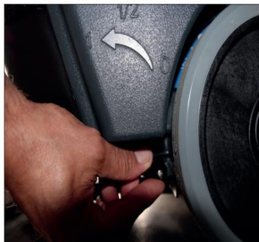
7. Öffnen Sie je nach Art und Reinigungsanforderung den Hahn für die Dosierung der Reinigungsmittellösung.
