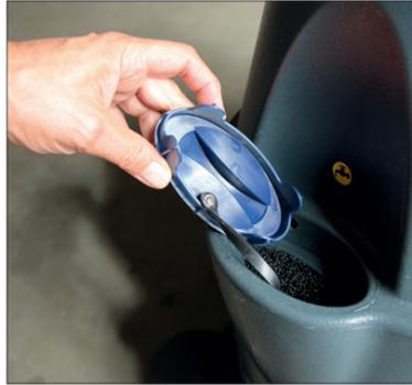
2. Befüllen Sie den Frischwassertank mit der Reinigungsmittellösung, (Mischverhältnisse beachten), des jeweiligen Reinigungsmittels. Die max. Temperatur der Lösung darf 40°C nicht übersteigen.
