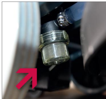
13. Reinigung des Filters: Nehmen Sie den durchsichtigen Deckel und den Abdichtungsring ab.
