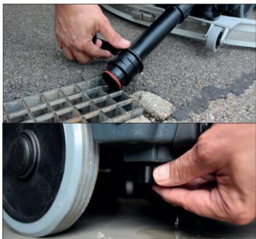
11. Entleeren und reinigen. Entleeren Sie den Schmutzwassertank mit dem Ablassschlauch. Anschließend entleeren Sie bitte den Frischwassertank mit dem Ablasshahn.
