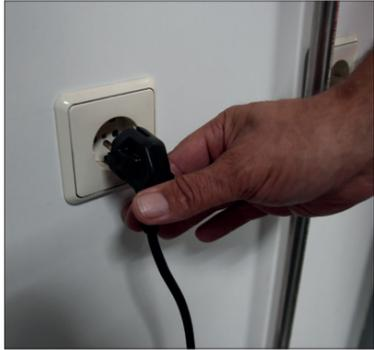
1. Entfernen Sie den Stecker des Ladegeräts aus der Steckdose.
