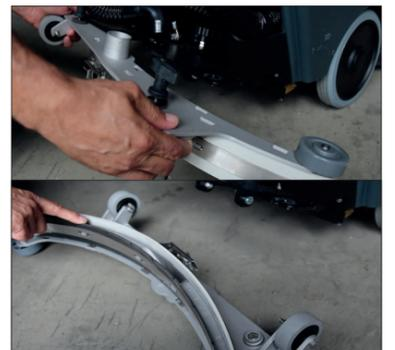
15. Demontieren Sie die Saugleiste und entfernen Sie den groben Schmutz.
