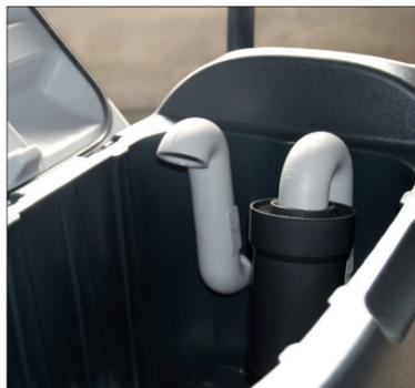
12. Spülen Sie mit sauberem Wasser den Schmutzwassertank und reinigen Sie den Schwimmer.
