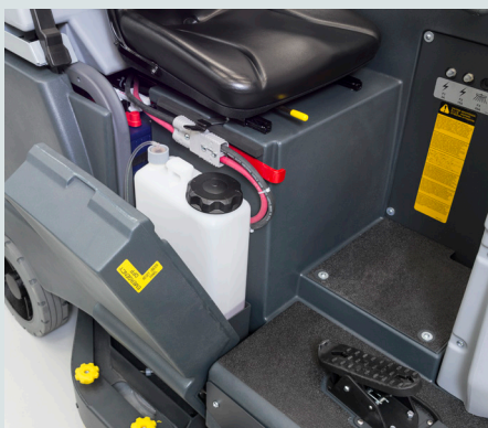
Ecoflex™-System (optional): Einfache Dosierung des Reinigungsmittels.
