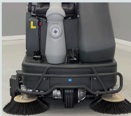
Zwei Seitenbesen (zylinderförmig) liefern eine randnahe Reinigung.
