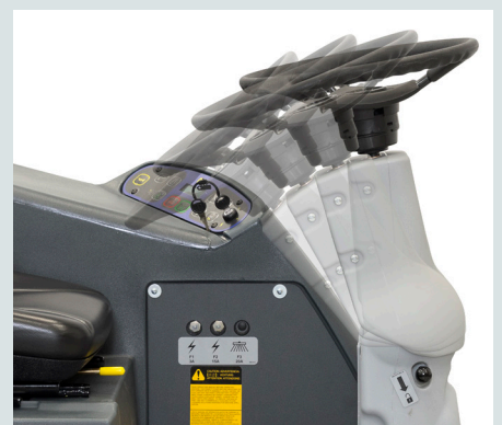
Kippbare Lenkeinheit für einfaches Einsteigen sowie ein ergonomisch gestalteter Fahrersitz für Sicherheit und Komfort.
