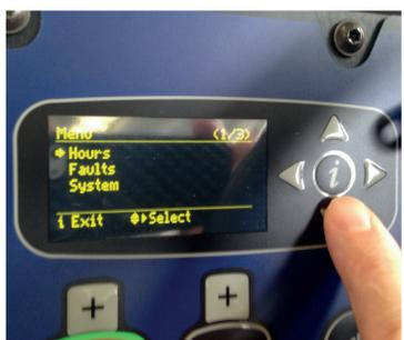
17. Gehen Sie in den Service-Test-Modus, indem Sie die „i“ Taste drücken und lesen Sie über die Pfeiltasten im Menü die Fehleranzeige aus.
