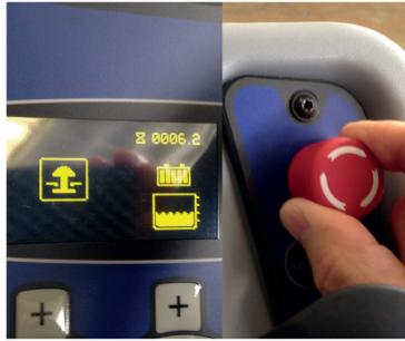
2. Das Notaus-Symbol erscheint auf dem Display, wenn der Schalter aktiviert ist. Drehen Sie den Schalter um zu den Maschinenfunktionen zu wechseln.
