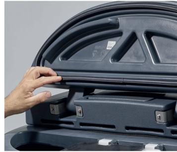
4. Schließen Sie den Schmutzwasser-tank richtig und/oder überprüfen Sie die Dichtung auf Verschleiß.
