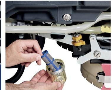
10. Öffnen Sie bei Bedarf das Frischwasserfiltergehäuse und reinigen Sie den Filtereinsatz.
