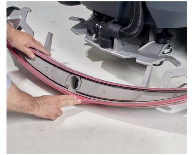
5. Prüfen Sie die Sauglippen auf Einschnitte oder Risse und ersetzen diese bei Bedarf.
