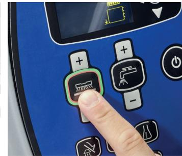
14. Stellen Sie sicher, dass sich das Deck und die Saugleiste beim Drücken der Taste nach unten bewegt.
