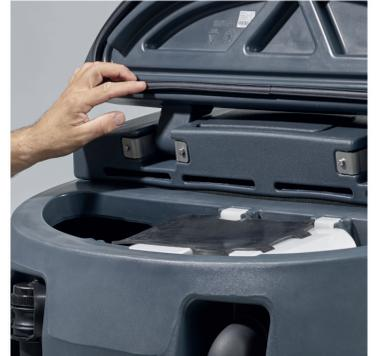
4. Schließen Sie den Schmutzwassertank richtig und/oder überprüfen Sie die Dichtung auf Verschleiß.
