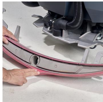
3. Überprüfen Sie, ob die Sauglippen beschädigt oder verschmutzt sind und diese ersetzen bei Bedarf.
