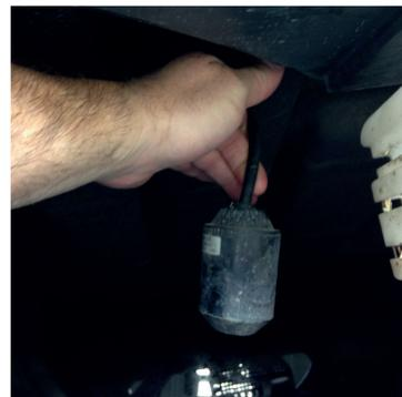
2. Öffnen Sie den Schmutzwassertank und überprüfen Sie, ob der Schwimmerschalter richtig funktioniert.
