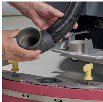
1. Überprüfen Sie, ob der Saugschlauch richtig montiert wurde und gereinigt ist.
