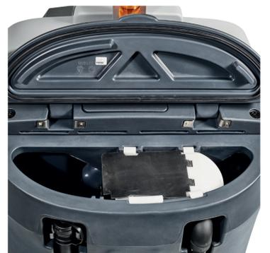
4. Die Dichtung im Deckel des Schmutzwassertanks muss richtig angebracht und in einem guten Zustand sein.
