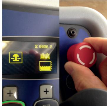
2. Das Notaus-Symbol erscheint auf dem Display, wenn der Schalter aktiviert ist. Drehen Sie den Schalter, um zu den Maschinenfunktionen zu wechseln.
