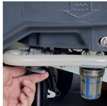
2. Überprüfen Sie, ob die Frischwasserleitung geöffnet ist.
