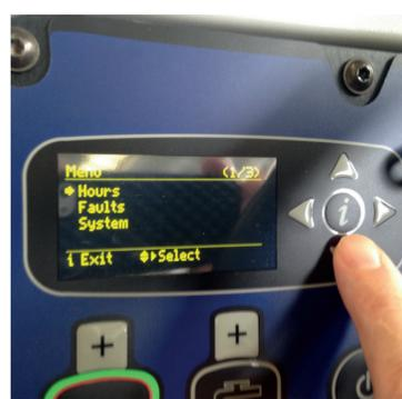
2. Gehen Sie in den Service-Test-Modus, indem Sie die „i“ Taste drücken und lesen Sie über die Pfeiltasten im Menü die Fehleranzeige aus.
